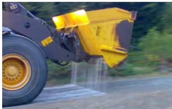
Bild 15: Saltpridarskopa på lastmaskin
